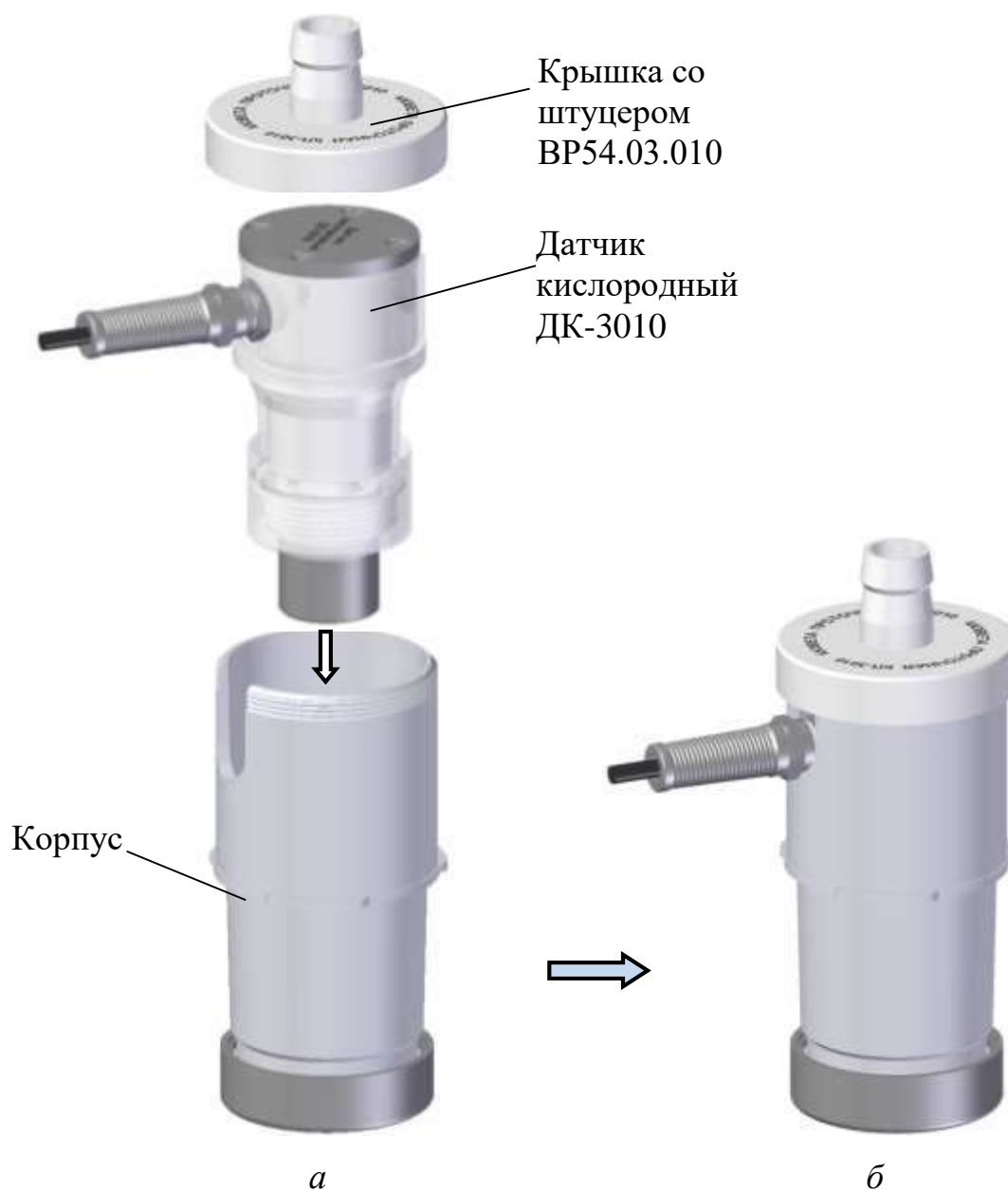
Рисунок 1.7 – Установка датчика в кювету
