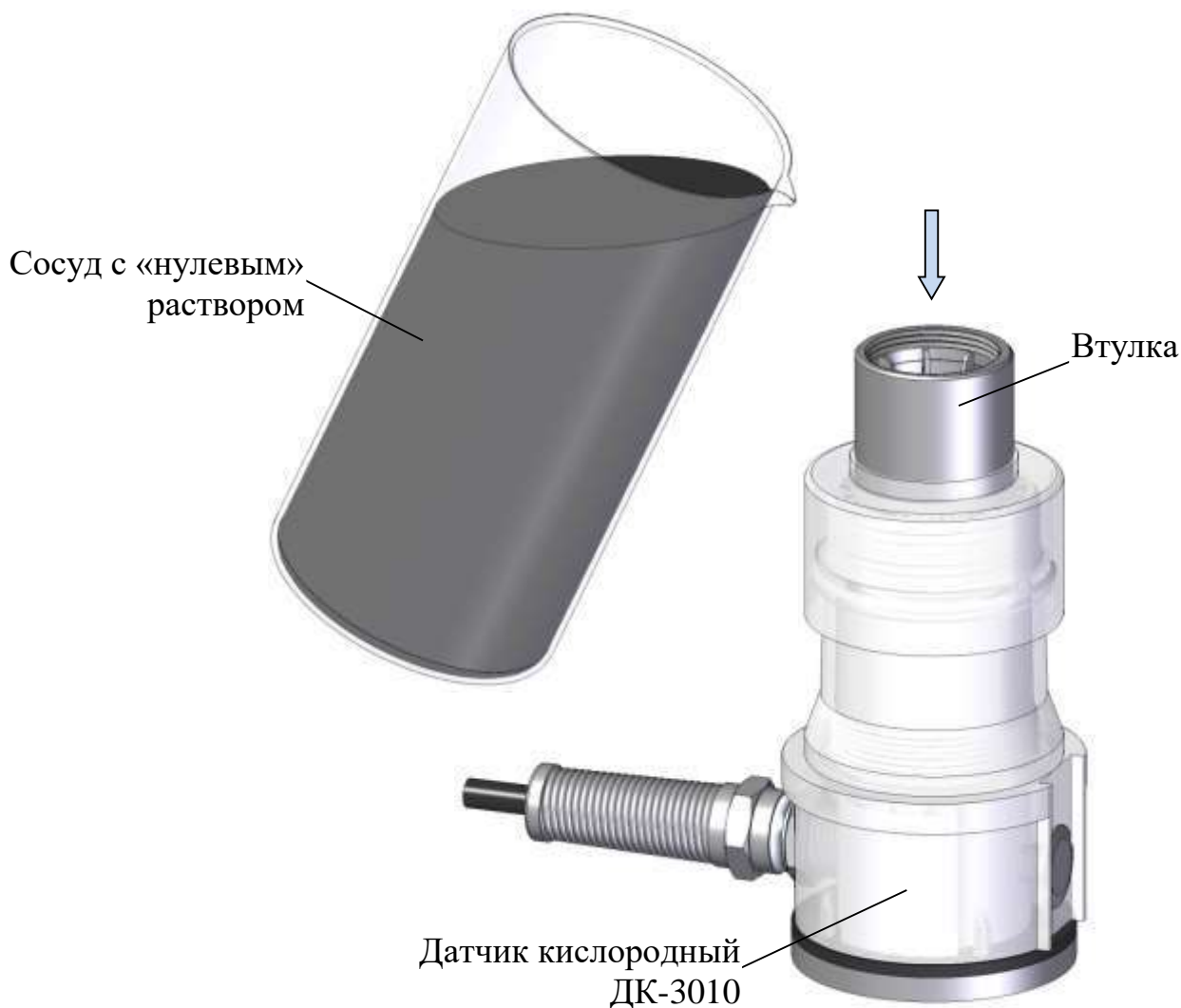
Рисунок 2.2 – Проверка показаний в «нулевом» растворе
